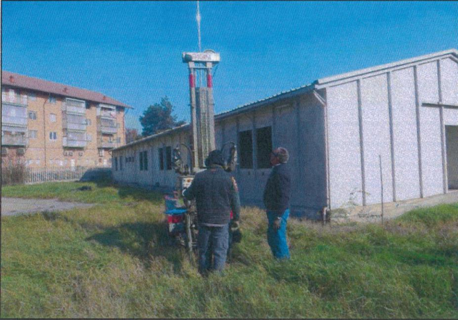
**Prova penetrometrica dinamica S3**
