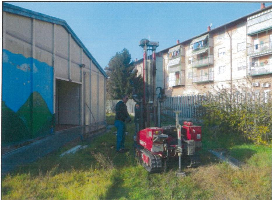
**Prova penetrometrica dinamica S1**
