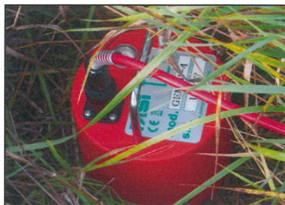
**Acquisizione dati prova sismica MASW  $V_{s,30}$  e HVSR**
