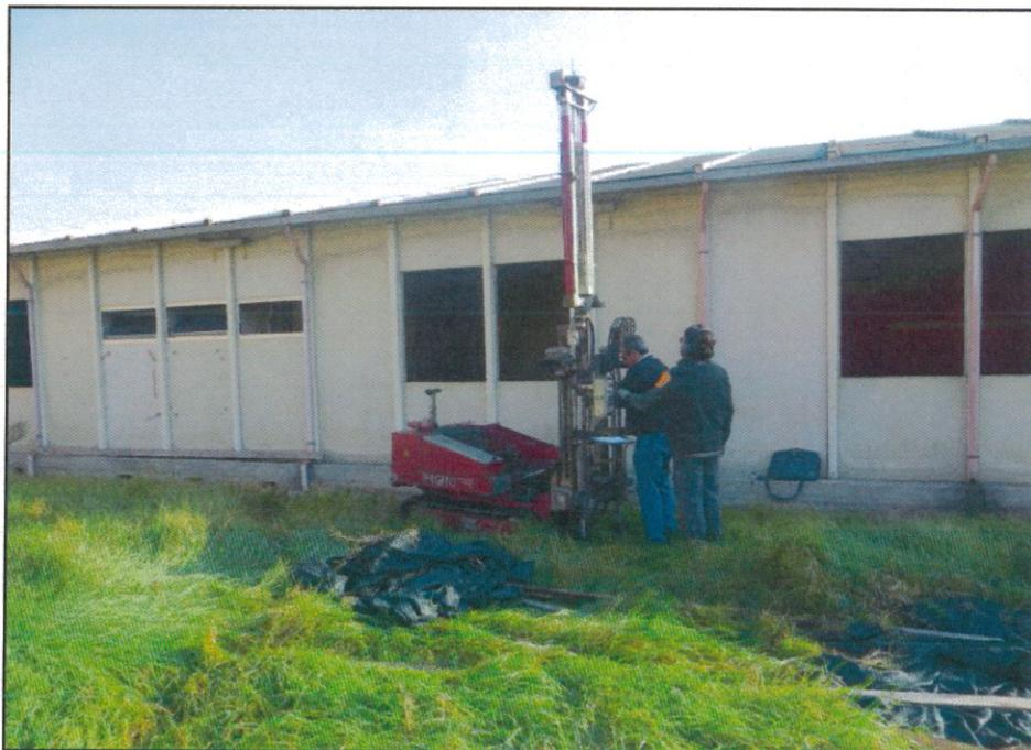
**Prova penetrometrica dinamica S2**
